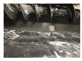
Поточный влагомер M-Sens 3-го поколения выполняет 3 функции: определение влажности продукта, определение температуры материала и контроль движения потока (что особенно важно при измерении влажности в шнеке).
