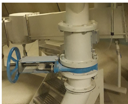
Рис. 2. Расходомер сыпучих материалов MaxxFlow
